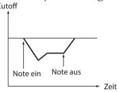
Je weiter der Regler nach rechts gedreht wird, desto höher die Intensität der Hüllkurve.
