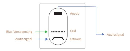
Die Modulation der Bias-Vorspannung ist die Summe der Parameter Threshold, Rectifier, Side Chain EQ, Attack und Release.
