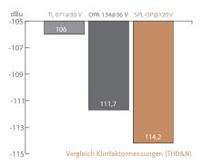
Unter Lautstärkebezug ist die 120-Volt-Technik also hinsichtlich Maximalpegel und Dynamikumfang doppelt so leistungsfähig wie herkömmliche Komponenten und Schaltungen, da die Werte um ca. 10 dB besser sind. Bei der Klirrmessung ist der SPL-OP noch mehr als 3 dB besser als der OPA 134 auf 36 V – unter Schalldruckpegelbezug entspricht das z. B. einer Verbesserung von mehr als 50%.
