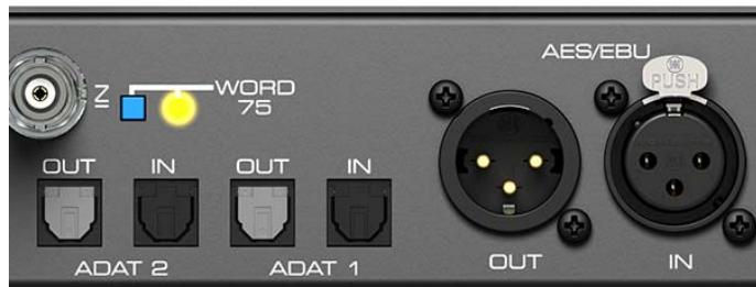
**ADAT2 I/O.** TOSLINK. Standard ADAT optical Port, 8 Kanäle. Kann nach Umschaltung im Settingsdialog auch als optischer SPDIF Ein- und Ausgang genutzt werden.
