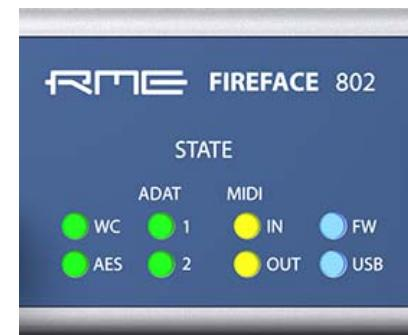
**MIDI LEDs.** Signalisieren für Ein- und Ausgang, ob MIDI-Daten empfangen oder gesendet werden.
