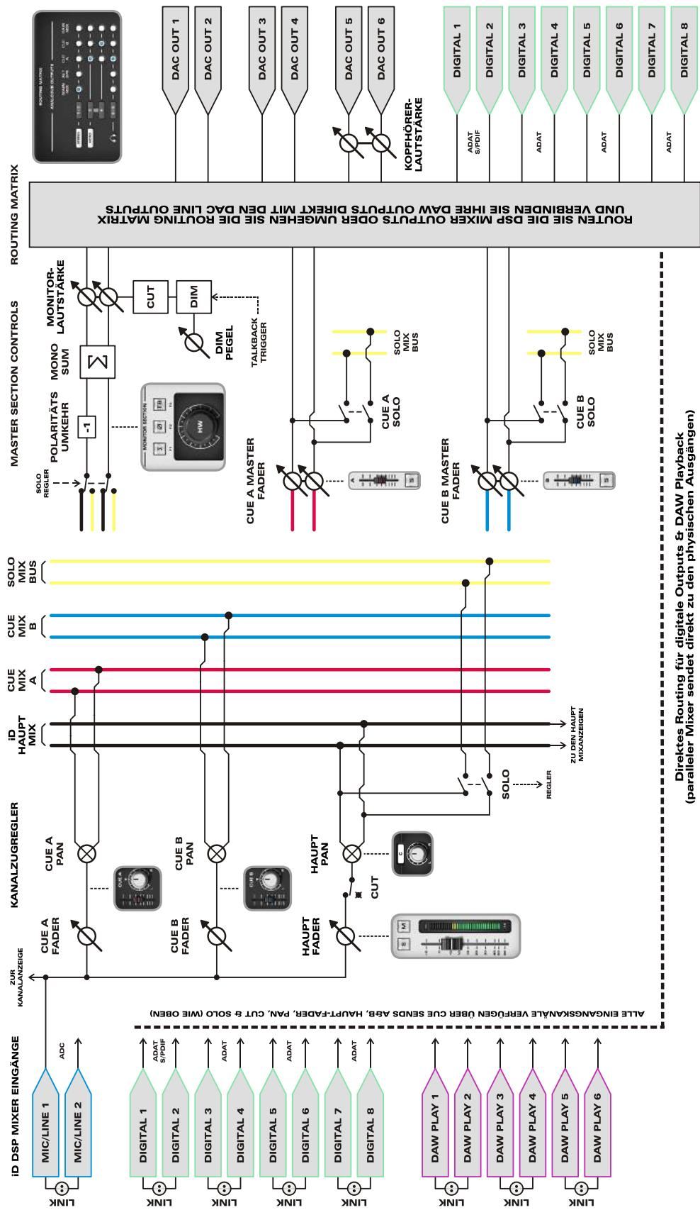
**iD22 ONBOARD DSP MIXER ANWENDUNG BLOCKDIAGRAMM**
