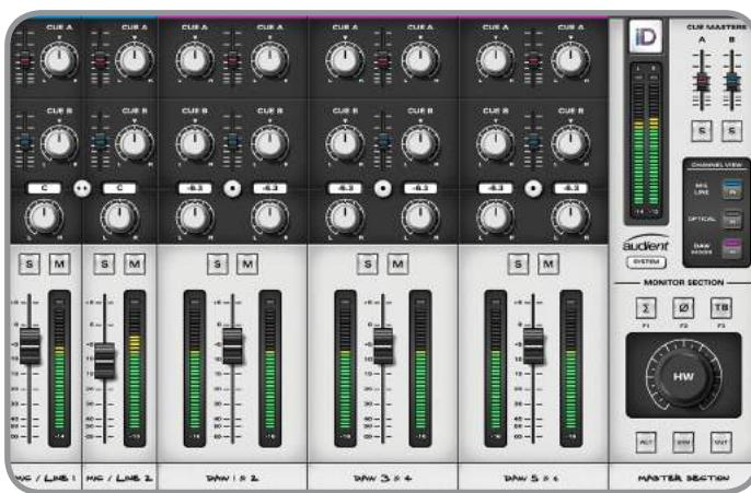
Für einfaches Monitoring/Abhören oder beim ITB Mischen bietet sich an, nur die Master-Sektion als Ansicht einzustellen. Oder wenn das iD22 über ADAT vollständig erweitert ist, etwa durch mit einem ASP008, können Sie alle Kanäle sehen (nach 10 Mono-Slots erscheint eine Scroll-Leiste).
