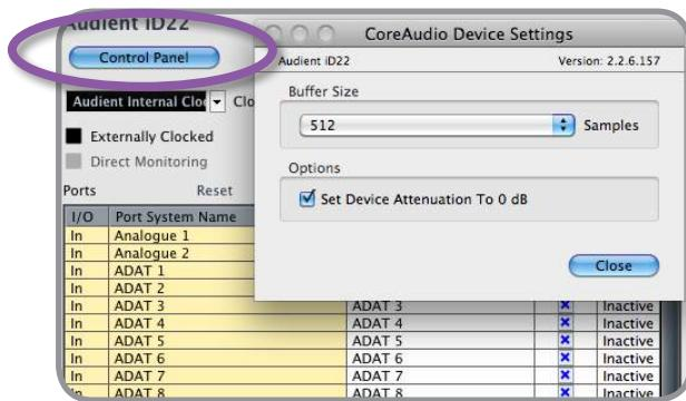
Sie können I/O Ports im Device Panel, entsprechend der Geräte die Sie daran anschließen, umbenennen (z.B. Hauptlautsprecher, alternative Lautsprecher, Hardware Process Loop). Das ist nützlich, denn alle Namen, die Sie hier auswählen, werden auch angezeigt, wenn Sie diese im Track I/O Routing zuweisen.
