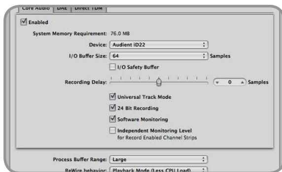
Wenn Sie den Onboard DSP Mixer des iD22 verwenden, um während der Aufnahme Eingangssignale abzuhören, müssen Sie das Logic Software-Monitoring deaktivieren, um Phasenauslösung zu vermeiden, weil Sie dieselbe Quelle zweimal mit einer kurzen Verzögerung zwischen dem DSP-Signal und dem verzögerten Software-Monitoring-Signal abhören.
