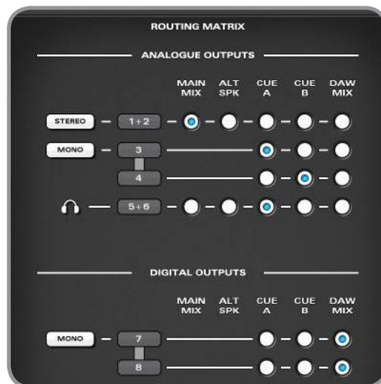
[Cue Master werden vor dem Routing an die DAC Ausgänge mono-summiert]. Diese Ausgänge würde man für die Speisung eines externen Kopfhörer-Verstärkers nutzen, um zwei Mono-Künstlermixe bereitzustellen. Selbstverständlich könnte man ein Stereo Cue Mix erstellen, indem man auf den Stereo/Monopfad Button drückt und Cue A oder B als Quelle auswählt.
