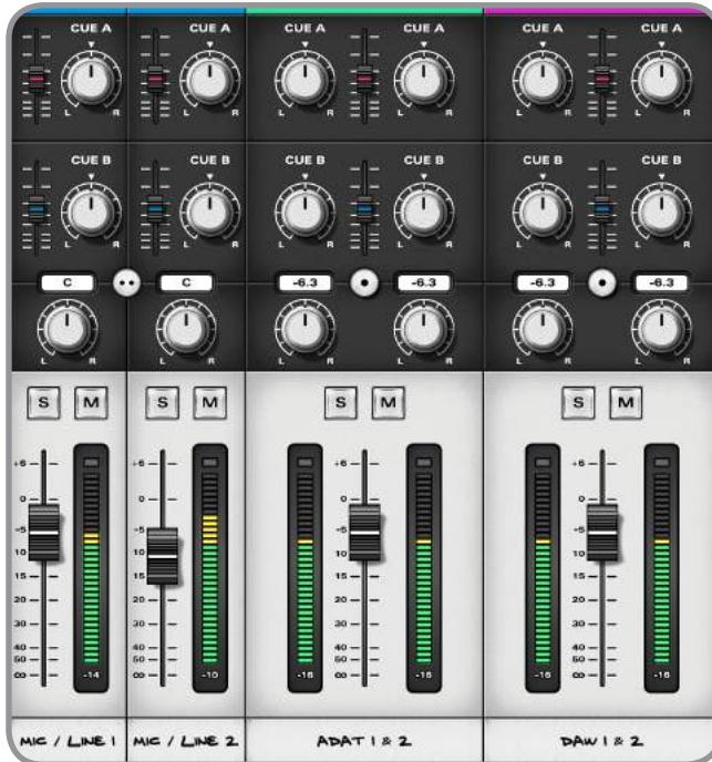
**Analoge** Eingangskanäle kommen direkt aus den zwei AD Wandlern (Insert Returns). Die verfügbaren Signale sind: Mikrofon, Line, DI (Kanal zwei) oder Unity-Gain-Line Eingang an der Return-Klinke.
