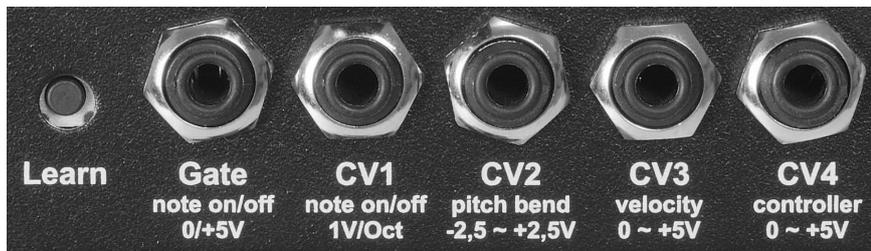
Entsprechend der eingehenden MIDI-Daten (Note On/Off, Notennummer, Pitchbend, MIDI-Controller, Velocity) erzeugt das Interface:
