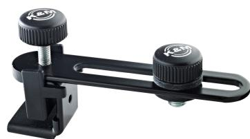
Preiswerte Halterung zum Anbringen von Mikrofonen an Drums, speziell Bass-Drum. Auf der Befestigungsschiene kann das Mikro stufenlos um bis zu 70 mm verschoben und nah an der Drum positioniert werden. Leichte Montage, unverlierbare Teile. Schwingungsdämpfung durch Gummischeibe und -einlage, "R.I.M.S" tauglich.
